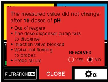
Questo messaggio di errore appare dopo 15/30 dosi di pH senza reazione della sonda.
