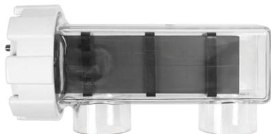
Uno dei componenti chiave del dispositivo ASIN AQUA Salt è l'elettrodo in titanio TE-25 con superficie in rutenioiridio, che consente l'elettrolisi dell'acqua della piscina e la generazione di cloro.
