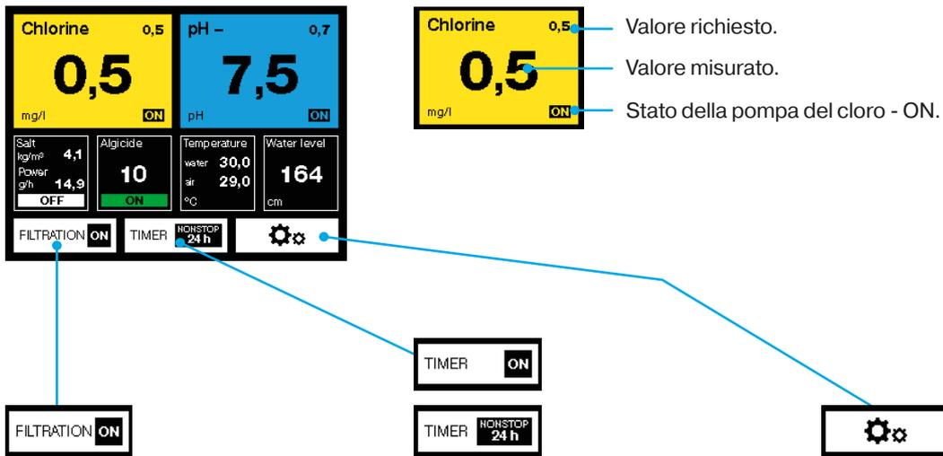
**ON** indica lo stato corrente della filtrazione. Il timer consente di impostare i periodi di filtrazione.
