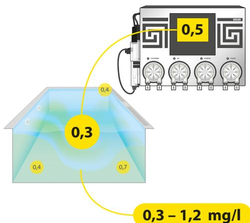
La calibrazione **non è necessaria** se la differenza tra il valore misurato del fotometro e il valore mostrato sul display è inferiore a **0,2 mg / litro**.
